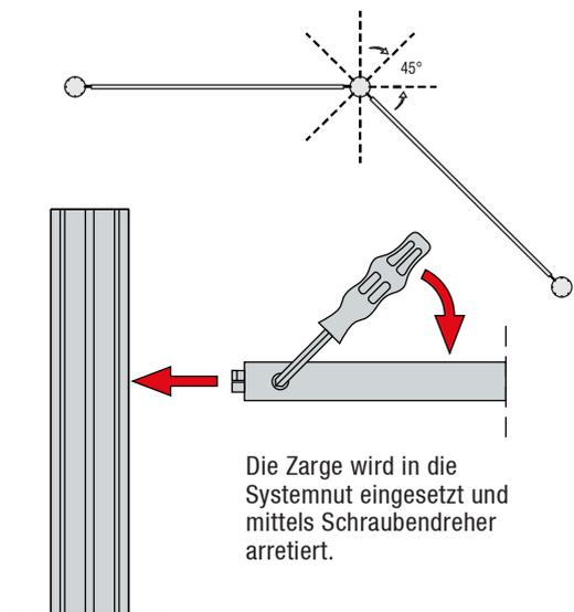
Die Zarge wird in die Systemnut eingesetzt und mittels Schraubendreher arretiert.
